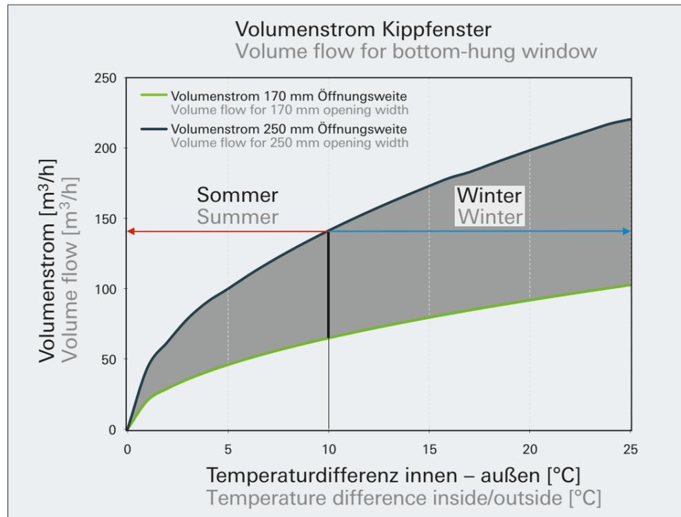
Vergleich Fensterluftwechsel Kippfenster Schüco TipTronic und Schüco TipTronic SimplySmart
